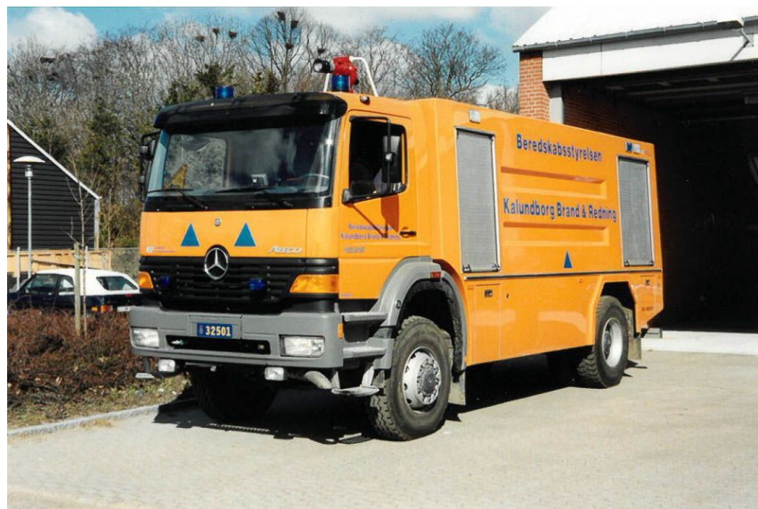
STP Kalundborg, MB 1828 Atego, 8000 l/m-pumpe, 2400 l/m-vandkanon. Foto: Jesper Lind Arpe.
