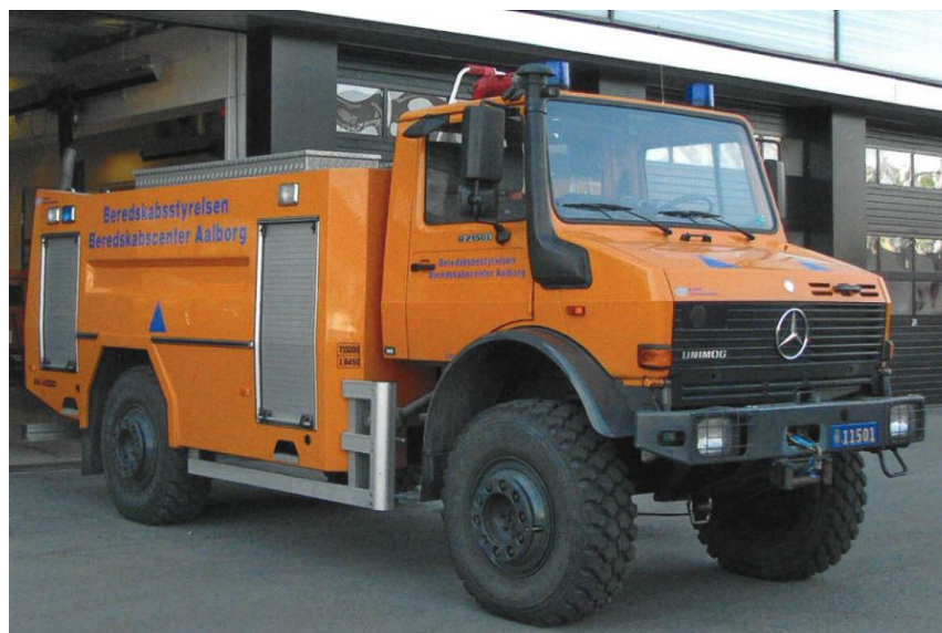
STP Aalborg, MB Unimog 2150 L, 4500 liter, 1600 l/m-pumpe, 2400 l/m-vandkanon. Foto: Jesper Lind Arpe.
